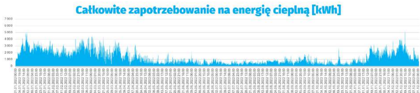
Rysunek 10. Wykres godzinowy produkcji gorącej wody z kotłów gazowych w zakładzie przetwórstwa papieru przed modernizacją
